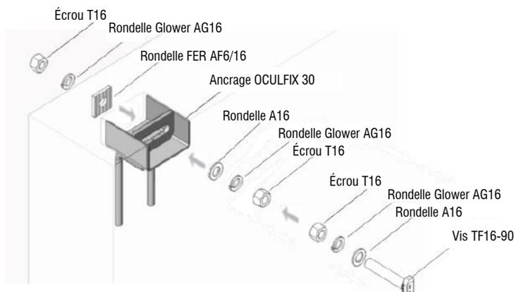
1.1.- Assemblez la vis FER TF16-90 avec les écrous T16, les rondelles Glowor AG16, les rondelles A16 et la rondelle FER AF6 / 16 à travers le trou d'ancrage OCULFIX30, comme indiqué sur la figure..
