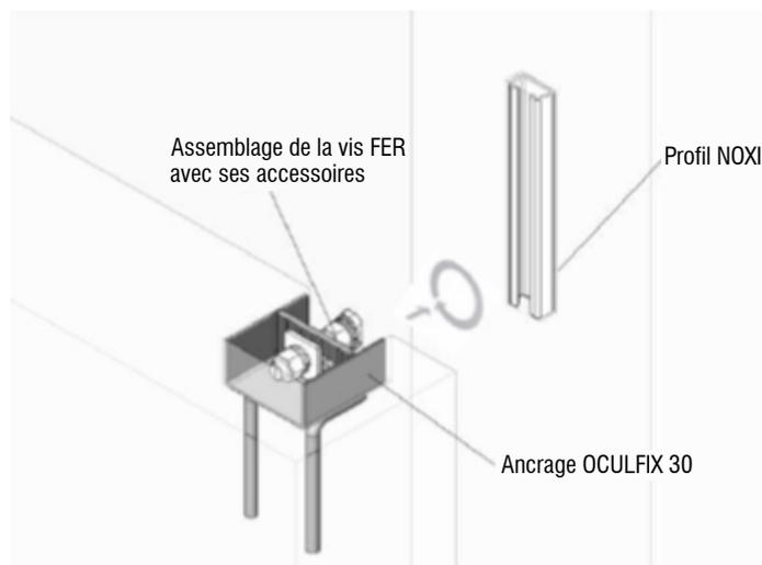
2.1.- Positionner l'élément à retenir par rapport à l'élément structural.
