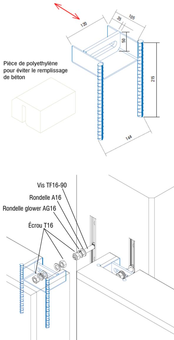
Accessoire caché pour retenir les éléments horizontaux préfabriqués en béton.
